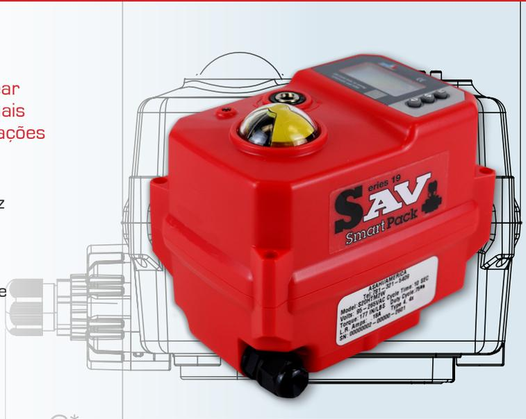
Atuador à prova de falhas opera com funções abrir/fechar enquanto se carregam os capacitores internos. Quando ocorre corte de energia, os capacitores descarregam e acionam a unidade para uma posição de falha predeterminada. Quando a energia é restaurada, os capacitores carregam novamente. Para diagramas de fiação e outros documentos técnicos, visite nosso site.
