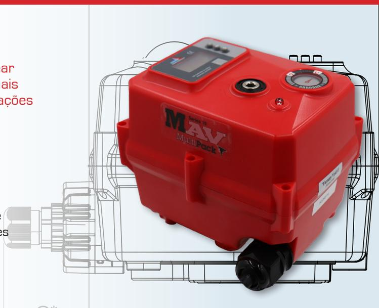
Atuador à prova de falhas opera com funções abrir/fechar enquanto se carregam os capacitores internos. Quando ocorre corte de energia, os capacitores descarregam e acionam a unidade para uma posição de falha predeterminada. Quando a energia é restaurada, os capacitores carregam novamente. Para diagramas de fiação e outros documentos técnicos, visite nosso site.
